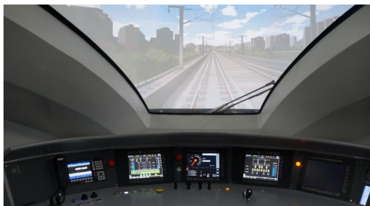
Рисунок 20. Тренажёр кабины машиниста
