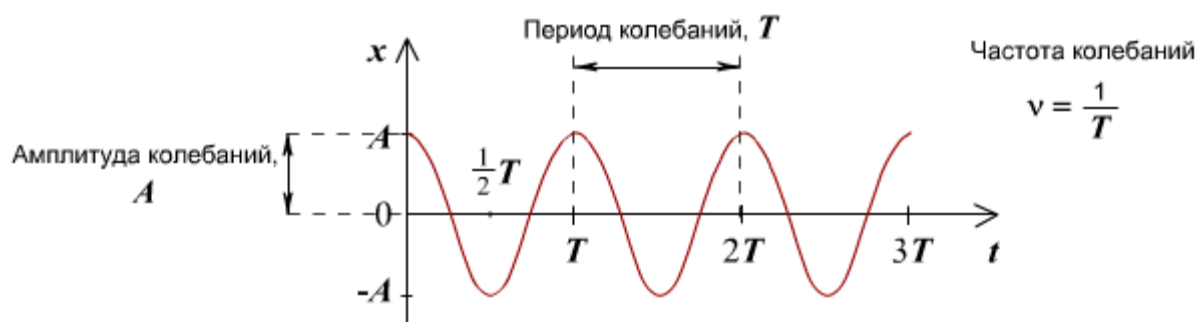
Рис. 2. Графическое представление параметров колебания валов.
