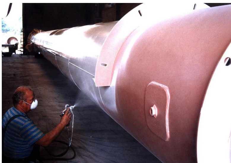
Рис. 2. Нанесение антикоррозийного грунта методом распыления
