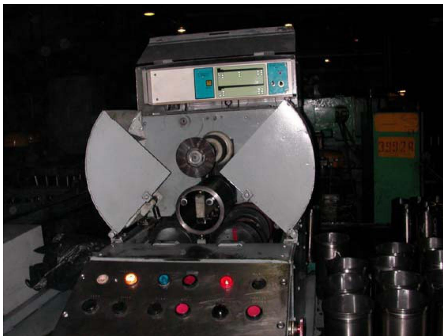
Рис. 1. Процесс дефектовки гильзы блока цилиндров дефектоскопом НТ-8
