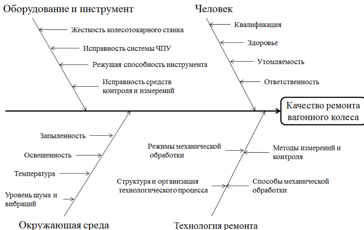
Рис. 1. Факторы, влияющие на качество ремонта вагонного колеса в виде диаграммы Исикава
