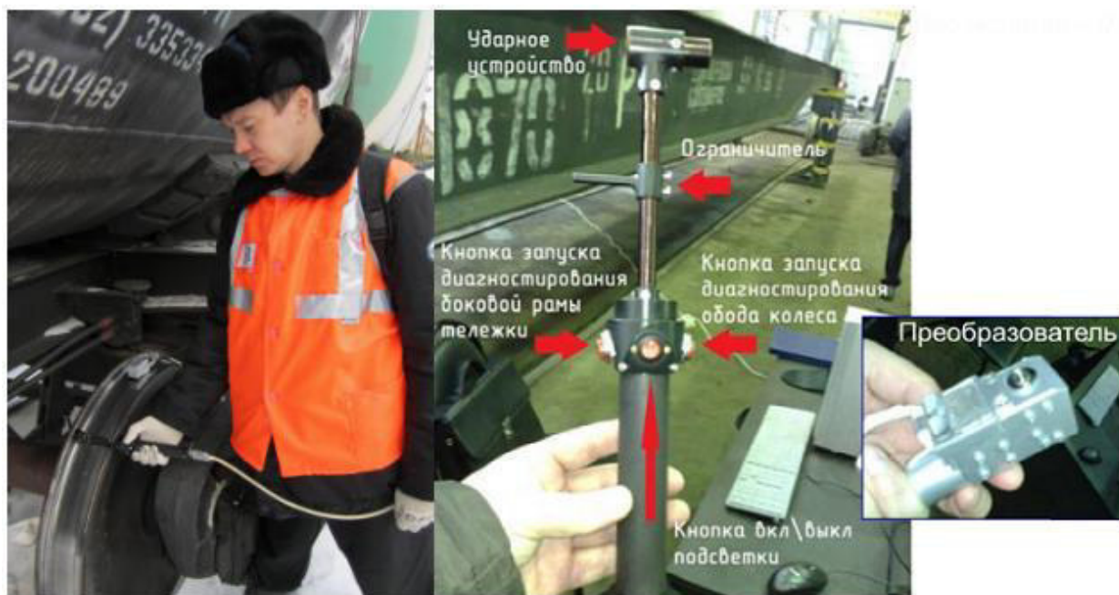
Рис. 3. Контроль боковой рамы тележки с помощью интеллектуального молотка контроля «ИМК».
