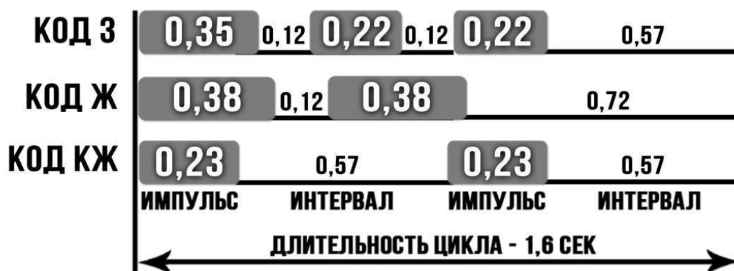
Рис. 1. Временные параметры числовых кодов КППШ–5.
