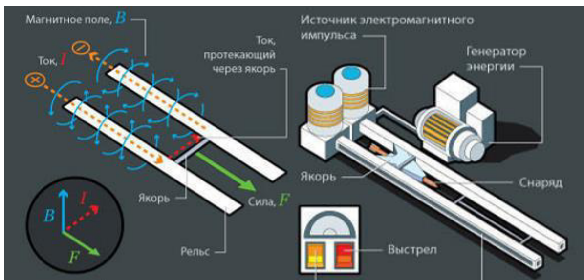
Рис. 1. Принцип действия и внутреннее устройство рельсотрона.
