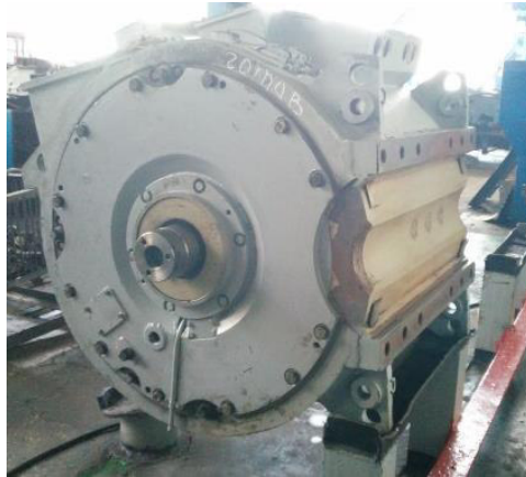
Рис. 1. Тяговый электродвигатель ЭК-810.
