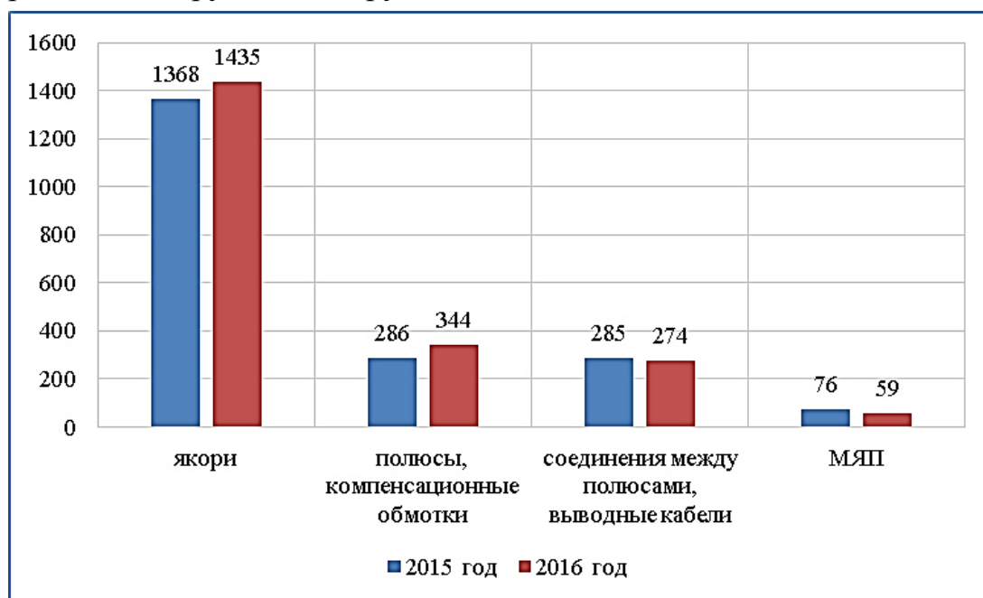
Рис. 1. Гистограмма выполнения ремонтов узлов ТЭД электровозов за 2015 - 2016 г.
