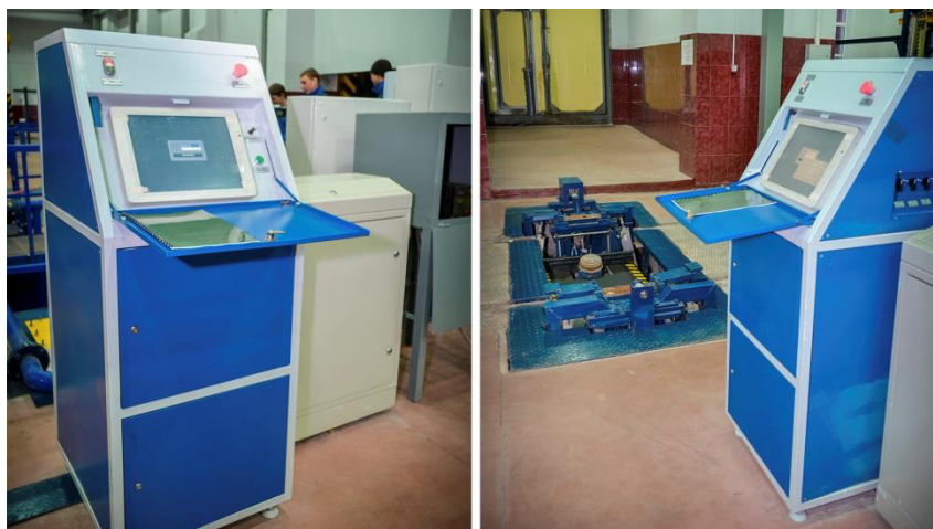
Рис. 4. Комплекс диагностирования буксовых узлов колесных пар «Эксперт Д»
