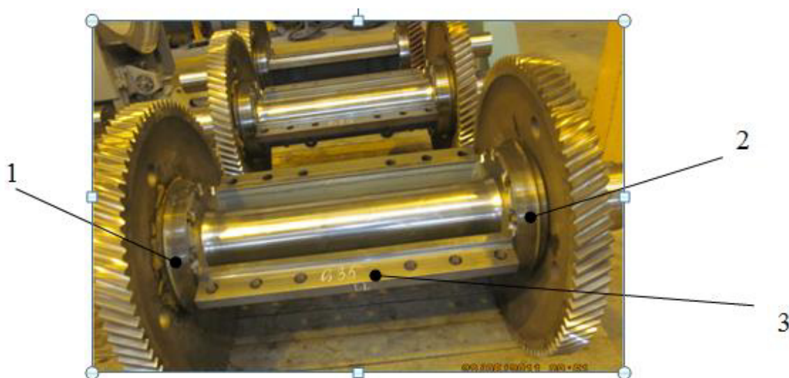
Рис. 4. Конструкция опорного узла ТЭД электровоза 2ЭС6: 1,2 – моторно-осевые подшипники качения; 3 – единый жесткий корпус
