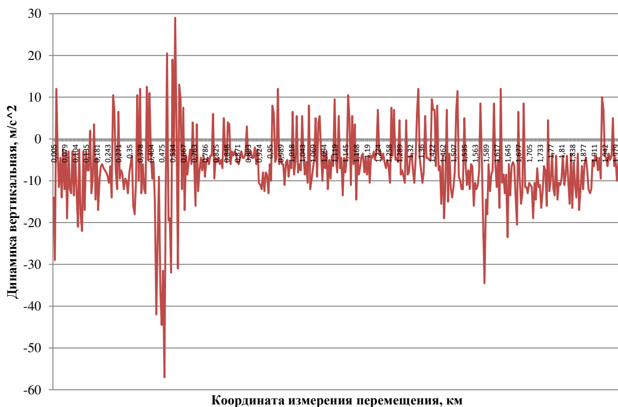
Рис. 2. Вертикальные нагрузки, возникающие в буксовых узлах при движении
