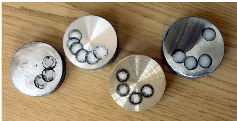
Рис. 3. Характерный вид пятен обжига на образцах разных типов сплава
