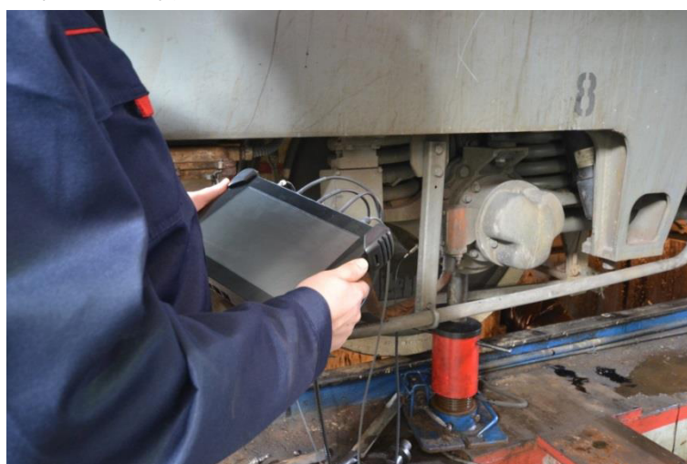
Рис. 5. Комплекс диагностирования колесно-моторных блоков локомотивов «Эксперт М»
