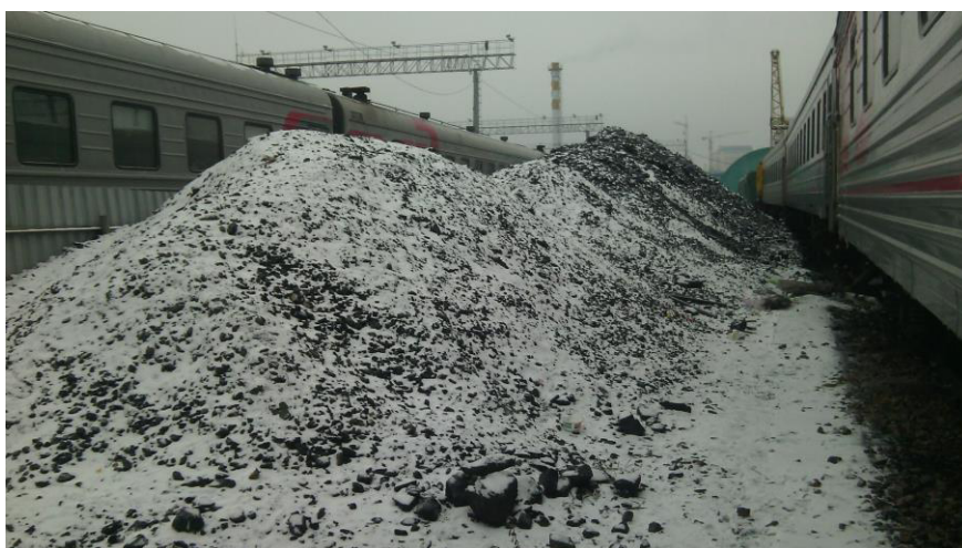
Рис. 1. Смерзшийся штабель угля при хранении на открытой площадке
