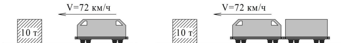
Рис. 1. Схема аварийного столкновения по сценарию 1
