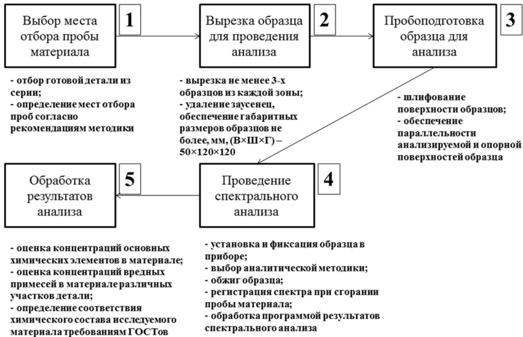
Рис. 1. Структура методики контроля качества материалов для изготовления боковой рамы и надрессорной балки
