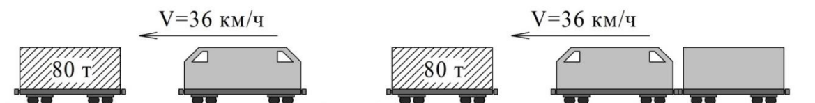
Рис. 2. Схема аварийного столкновения по сценарию 2
