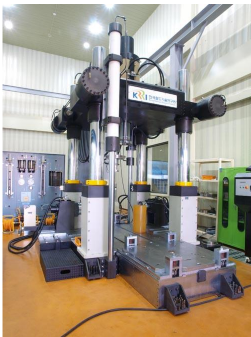
Рис. 4. Большая трех-координатная система испытания балласта (основания пути)
