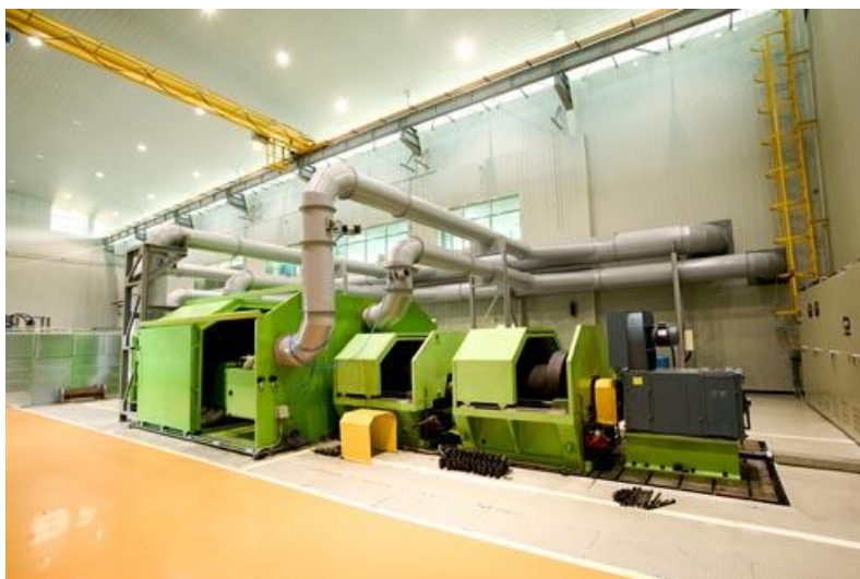
Рис. 6. Испытания эффективности систем торможения
