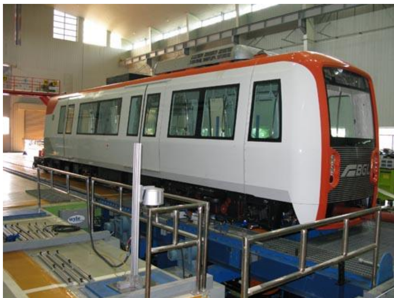
Рис. 5. Динамические испытания модели кузова
