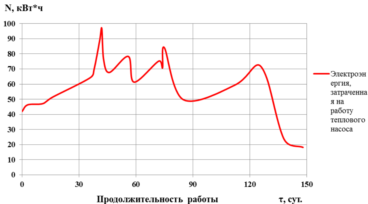
Рис. 3. Потребление электроэнергии тепловым насосом в течение отопительного периода
