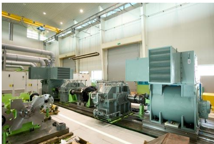
Рис. 7. Испытательная станция элементов привода
