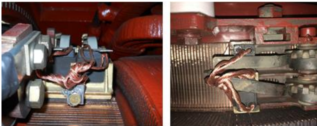
Рис. 3. Конструктивные решения щеточно-коллекторного узла
