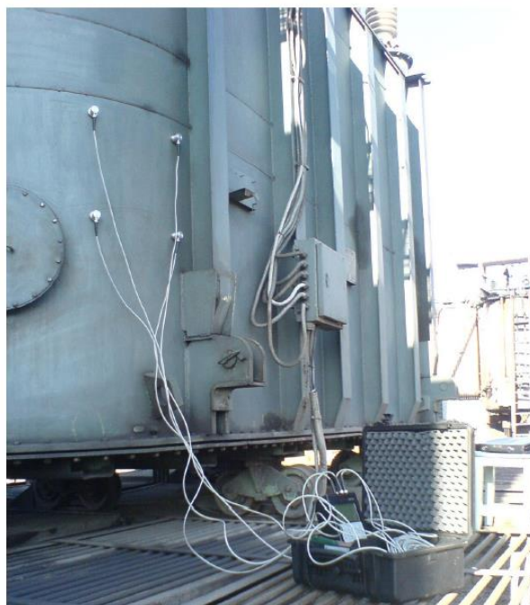
Рис. 1. Установка преобразователей акустической эмиссии
