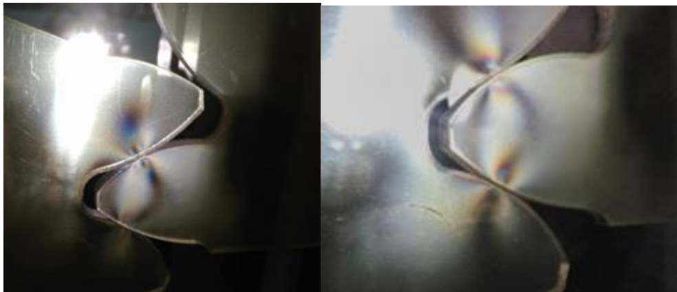
Рис. 2. Интерференционная картина в зоне контакта зубьев образцов
