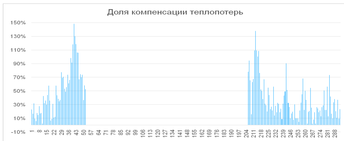
Рис. 7. доля компенсации тепловых потерь
