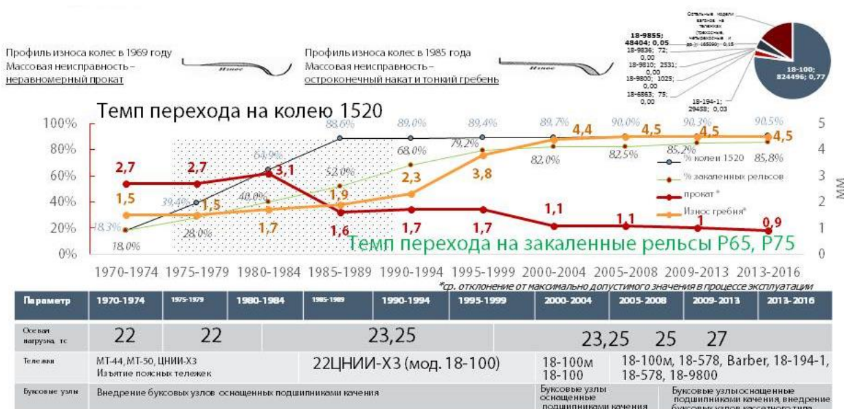
Рис. 6. Влияние ширины колеи и твердости рельсов на работу системы «колесо-рельс»
