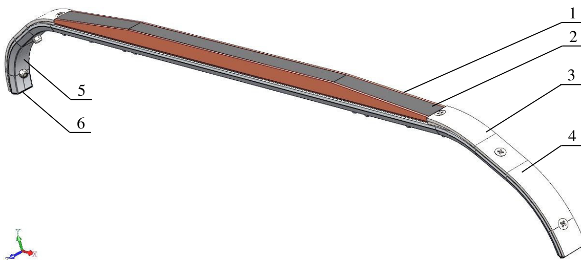
Рис. 1. Конечно-элементная модель полоза токоприемника SSS 87, установленного на электропоезде Сапсан: 1 – медная обойма, 2 – импегнированный углеграфит, 3 – клиновидная накладка, 4 – защитная накладка, 5 – алюминиевый каркас, 6 – пластиковая заглушка
