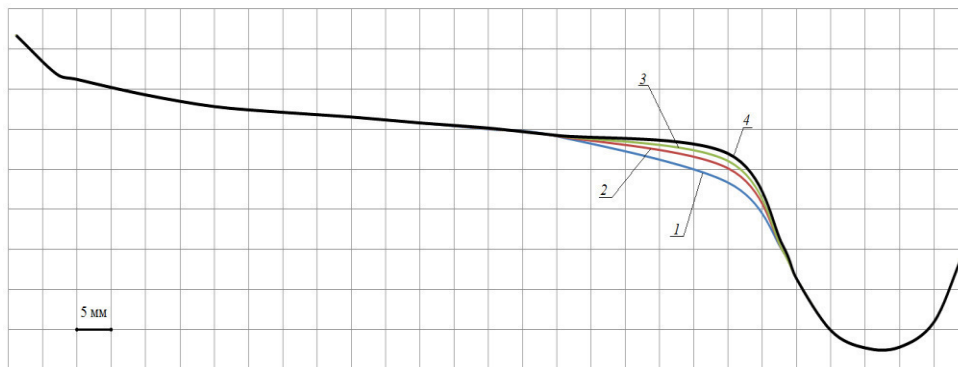
Рис. 6. Эволюция профиля колеса после обработки ТС НИОД:
