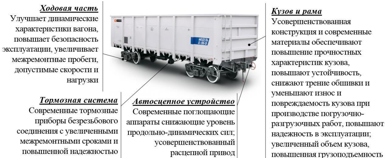
Рис. 2. Конструкционные преимущества инновационных вагонов
