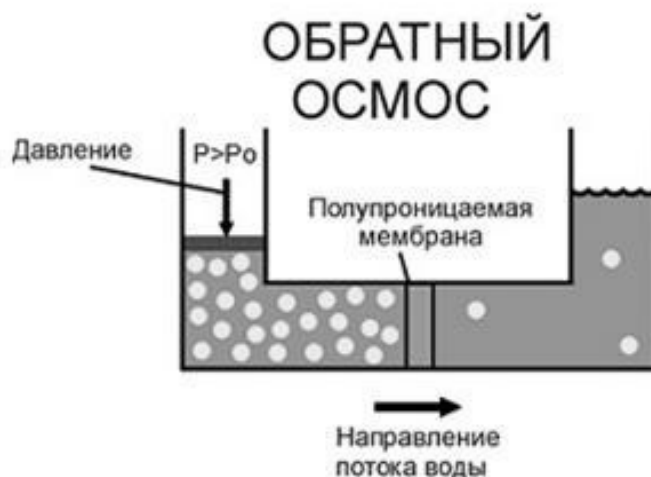
Рис. 3. Схема работы метода обратный осмос
