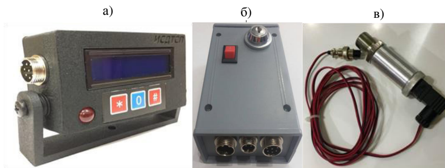
Рис. 4. Прототип системы диагностики тормозной сети поезда: а) блок индикации, б) блок коммутации, в) датчик давления
