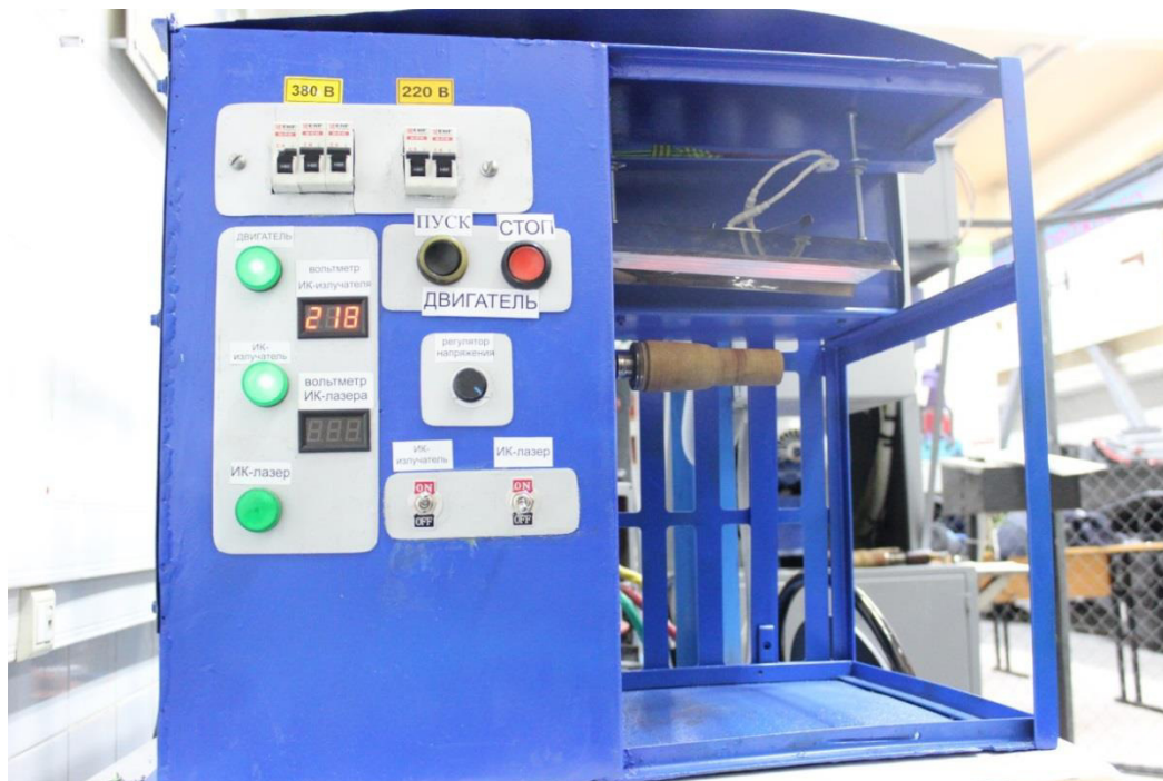
Рис. 4. Общий вид лабораторной установки для восстановления лаковой пленки изоляционного пальца
