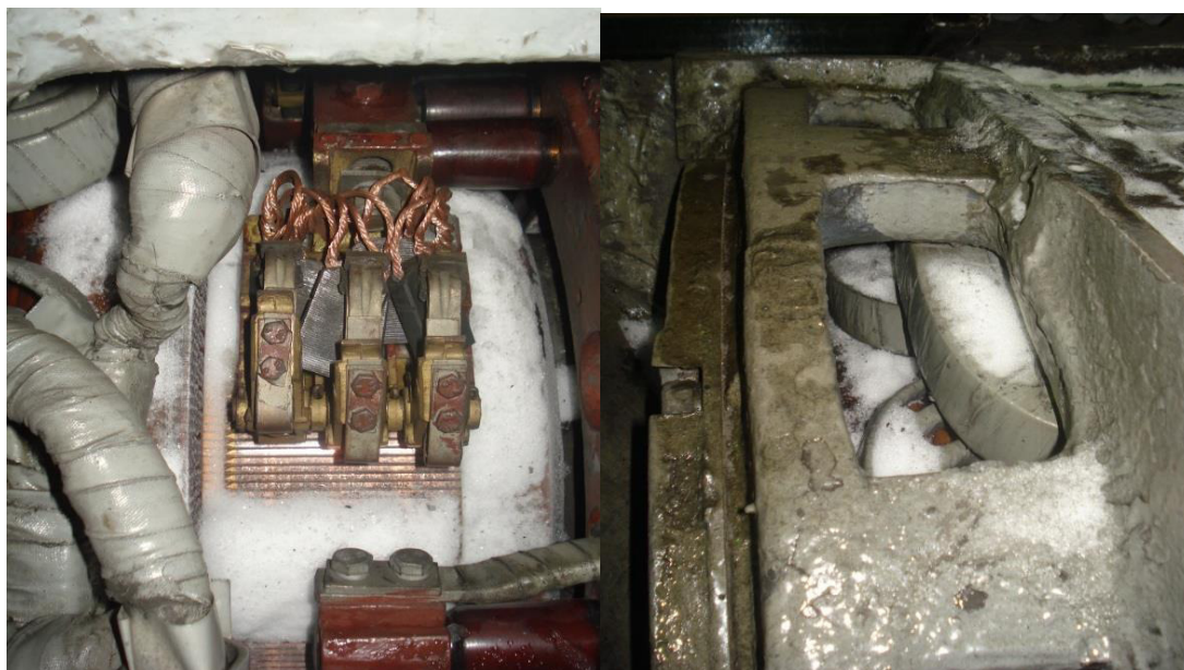
Рис. 6. Наличие снега в районе коллекторно-щеточного узла и магнитной системы тягового электродвигателя
