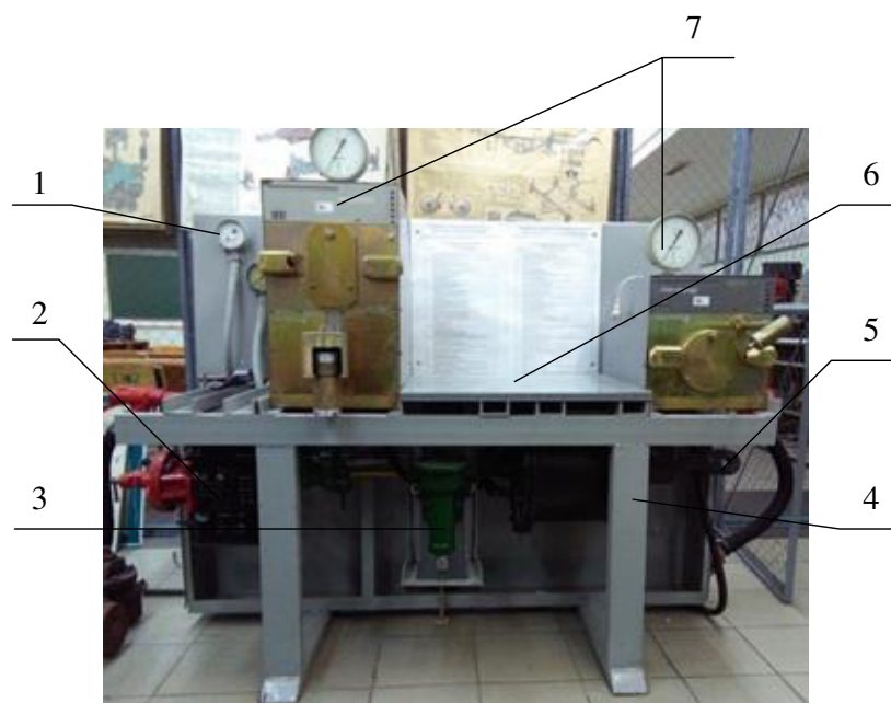
Рис. 3. Физическая модель пневматической части тормозной системы грузового вагона: 1 – манометры; 2 – воздухораспределитель №483; 3 – авторегулятор режимов торможения; 4 – станина станда; 5 – тормозной цилиндр; 6 – рабочее место для персонального компьютера; 7 – тормозоиспытательные стенды «Тормо»
