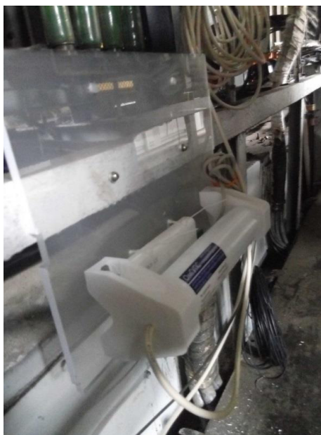
Рис. 5. Установка БИ в высоковольтной камере электровоза и подключения к шунту для измерения тягового тока на электровозе ВЛ-10
