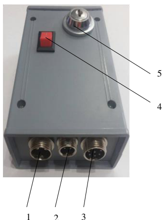
Рис. 2. Внешний вид блока коммутации: 1 – разъем питания устройства; 2 – разъем питания преобразователя давления КРТ-9; 3 – разъем питания и обмена данными блока коммутации и дисплейного модуля; 4 – тумблер включения устройства; 5 – замок
