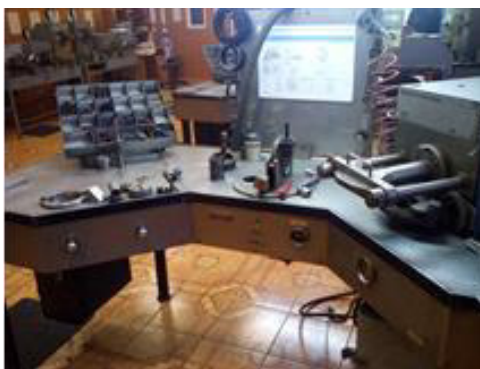
Рис. 2. Стол ремонта и проверки главной части воздухораспределителей
