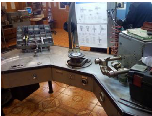
Рис. 1. Стол ремонта и проверки магистральной части воздухораспределителей
