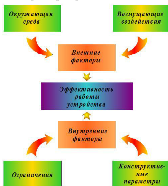
Рис. 3. Факторы влияния на эффективность работы устройства для разрушения ледяной корки
