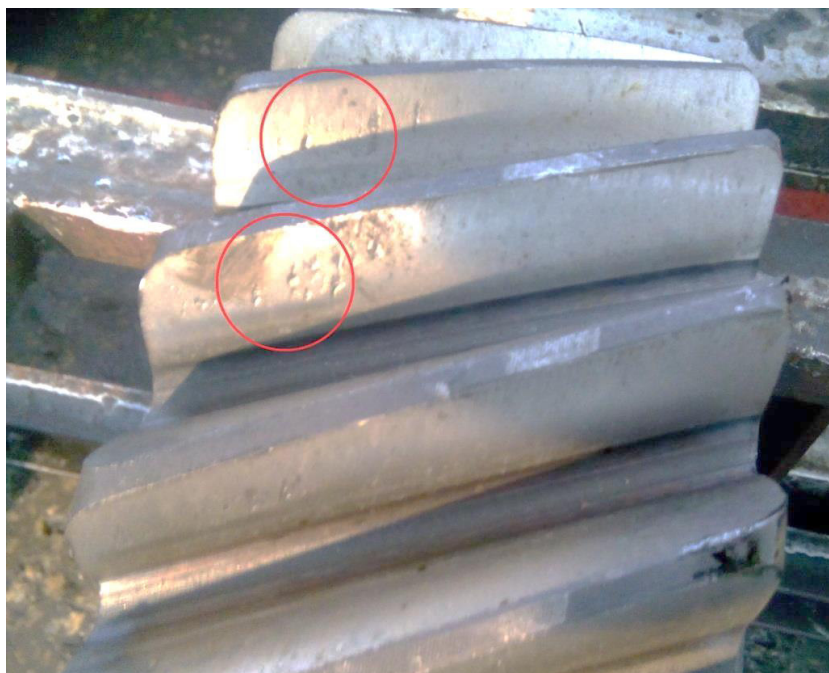
Рис. 1. Выкрашивание рабочей поверхности зубьев и смещение пятна контакта
