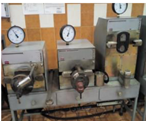
Рис. 3. Устройство контроля автоматических регуляторов режимов торможения
