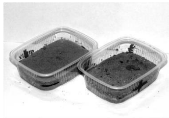
Рис.1. Газобетон без золы. Рис. 2. Газобетон с древесной золой
