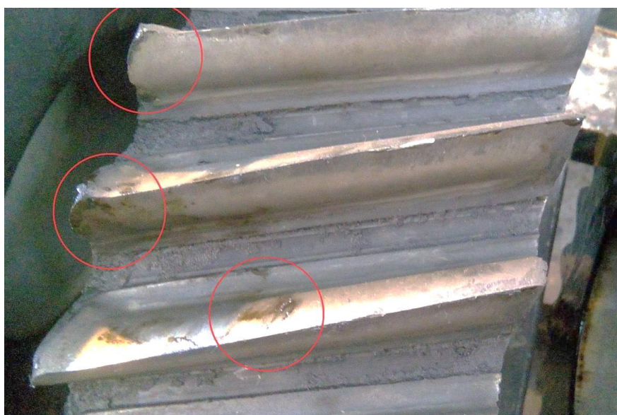
Рис. 2. Пластический сдвиг и прижоги на поверхности зубьев
