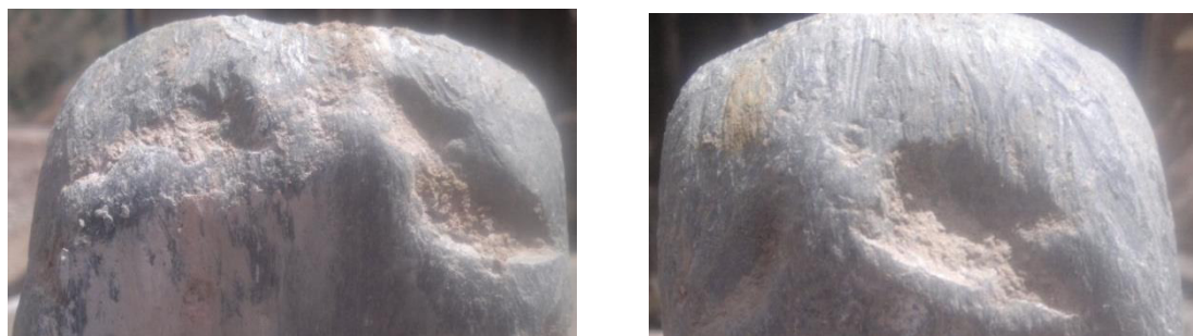
Рис. 3. Задние поверхности зубьев с выкрашиваниями наплавленного металла
