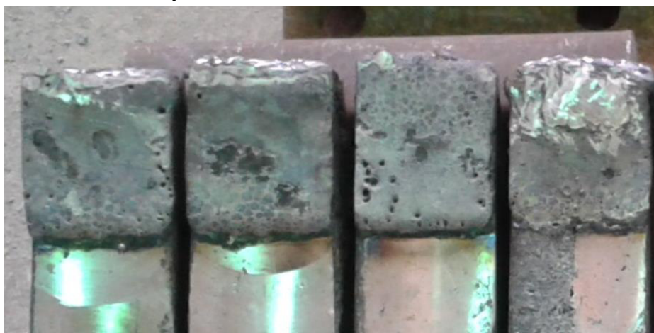
Рис. 2. Наплавленные поверхности зубьев ковша экскаватора
