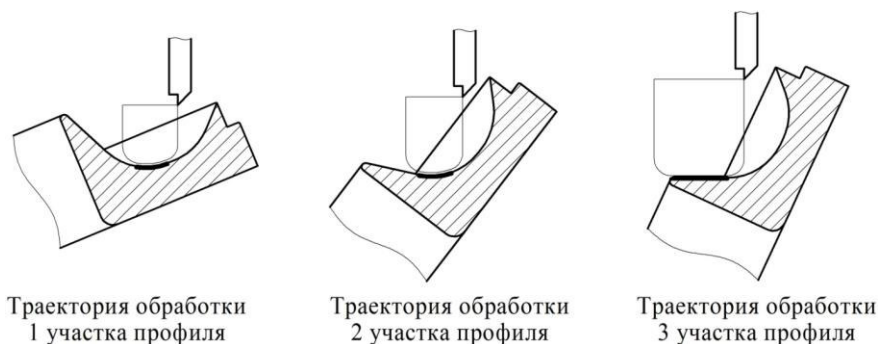
Рис. 4. Траектория обработки на 5-ти осевом фрезерном станке с ЧПУ
