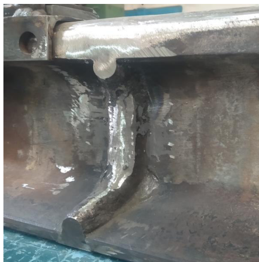
Рис. 1. Рельсы, сваренные электрошлаковым способом
