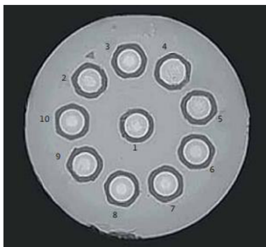
Рисунок 5 – Поперечное сечение 10-сердцевинного волокна
