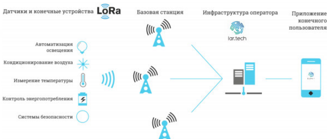
Рисунок 3 – Принципиальная схема построения сети LoRaWAN
