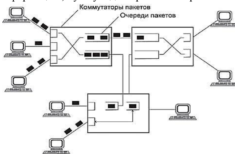
Рисунок 2 – Структура пакетной коммутации
