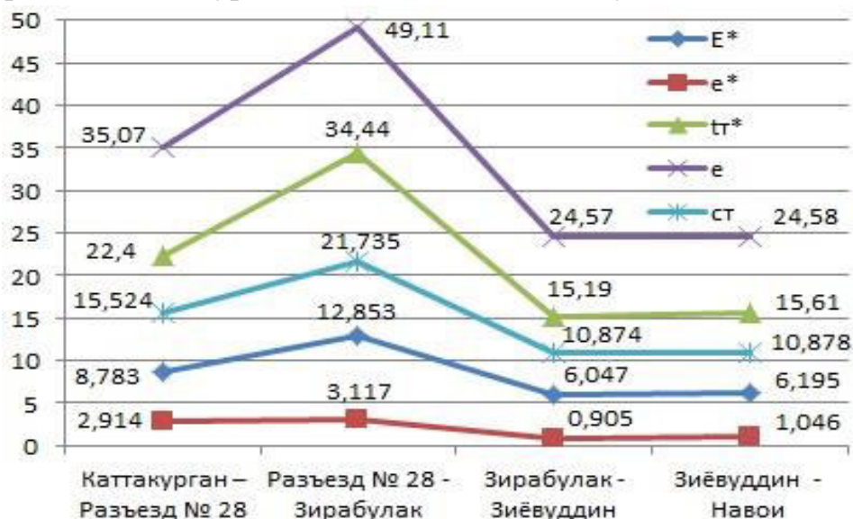
Рисунок 1 – Графики показателей перевозочной работы тепловозов ЗТЭ10М на участке Каттакурган – Навои, движение без остановок
