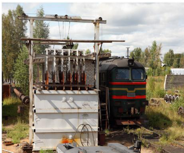
Магистральный тепловоз на позиции реостатных испытаний
