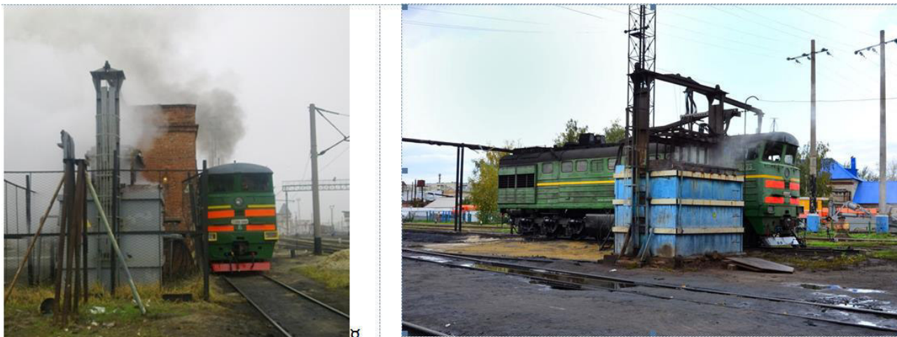
Рис. 1. Станции реостатных испытаний тепловозов с жидкостным нагрузочным реостатом
