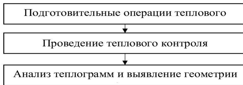
Рисунок 1 – Принципиальная схема теплового контроля рефрижераторного контейнера
