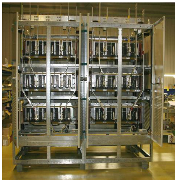
Рисунок 6 – Выпрямитель 12 МВт с естественным охлаждением
