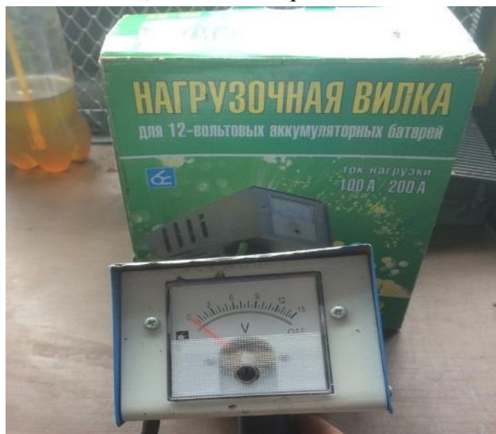
Рисунок 1 – Нагрузочная вилка с стрелочной шкалой измерения
