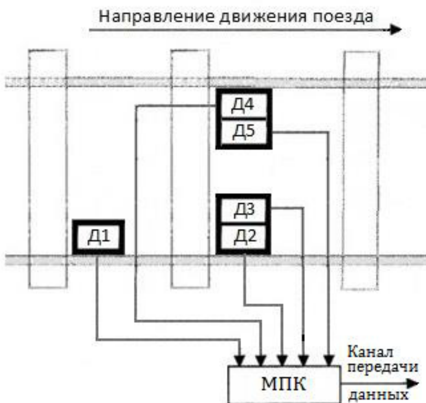
Рисунок 1 – Схема размещения датчиков на железнодорожном пути
