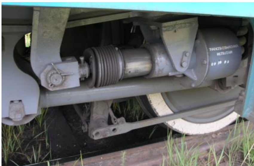
Рисунок 6 – Тормозной цилиндр со встроенным авторегулятором выхода штока (электровозы 2ЭС6 и 2ЭС10)
