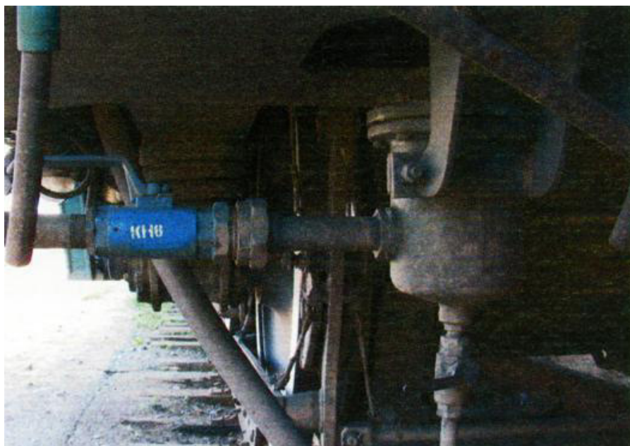
Рисунок 3 – Влагомаслоотделитель и кран КН8
