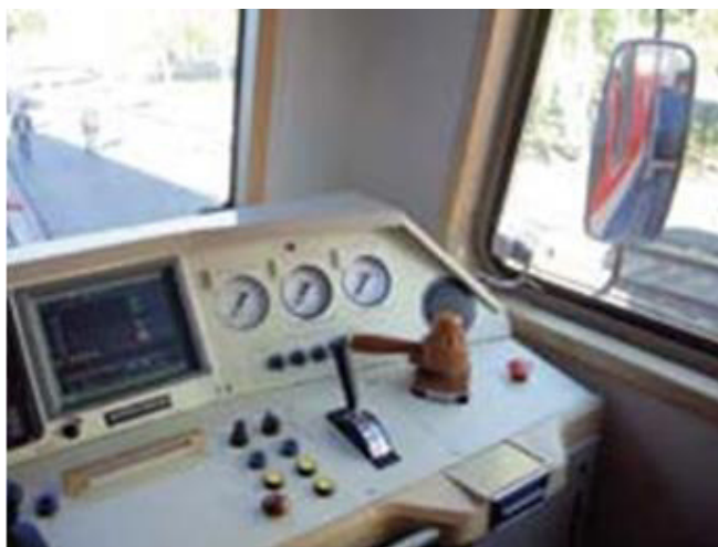
Рисунок 5 – Контроллер ККМ крана дистанционного управления тормозами № 130 и кран вспомогательного тормоза № 215 на пульте кабины управления электровоза 2ЭС6
