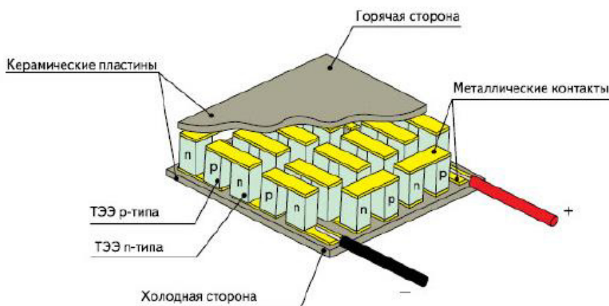
Рисунок 3 – Термоэлектрический модуль в разрезе
