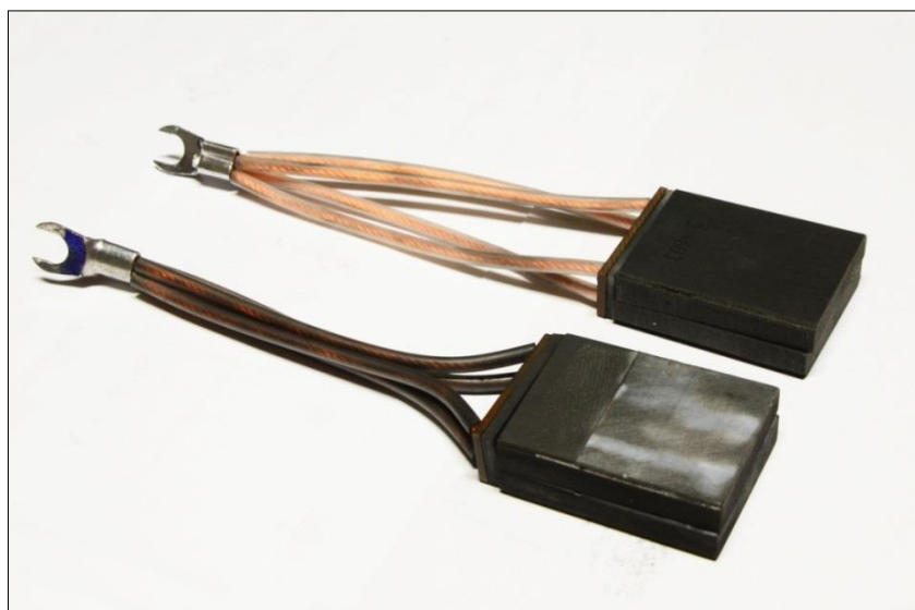
Рисунок 6 – Сравнение оригинальной и обновленной щетки EG680
