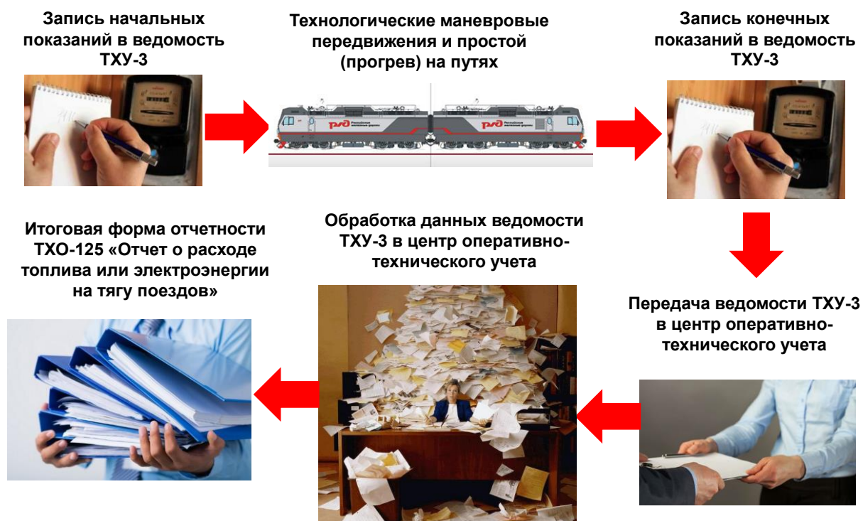
Рисунок 2 – «Ручной» способ контроля и управления за потреблением электроэнергии ЭПС в границах тракционных путей локомотивных депо и пунктов оборота локомотивных бригад
