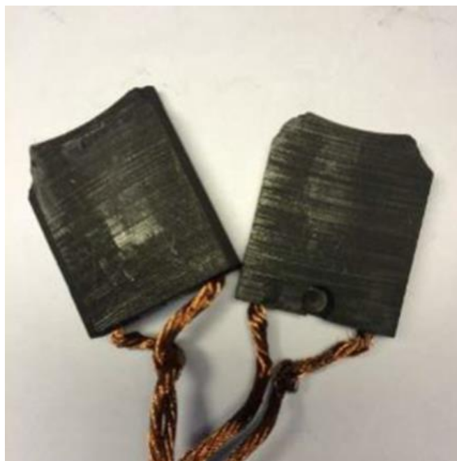
Рисунок 3 – Состояние ЭЩ узла заземления при усилии 3,1 кгс
