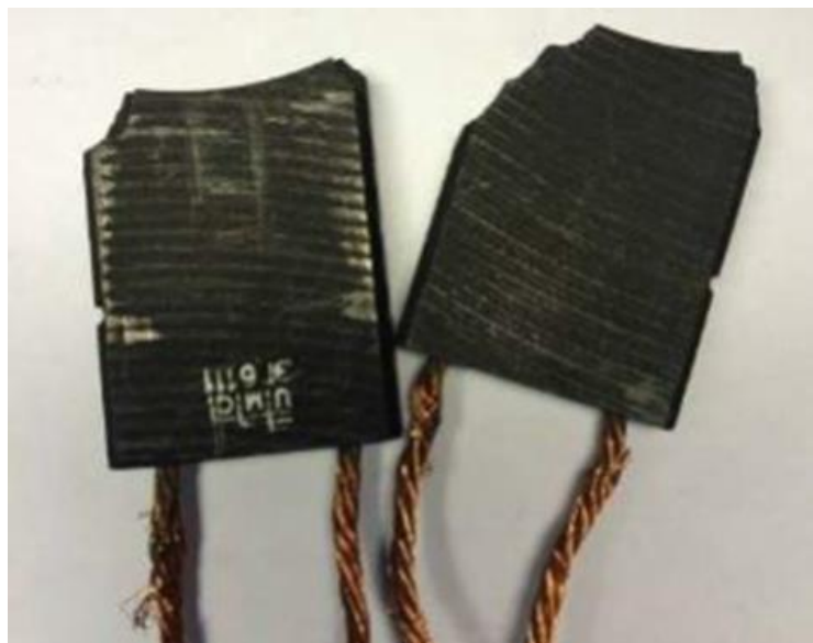
Рисунок 2 – Состояние ЭЩ узла заземления при штатном усилии 2,6 кгс
