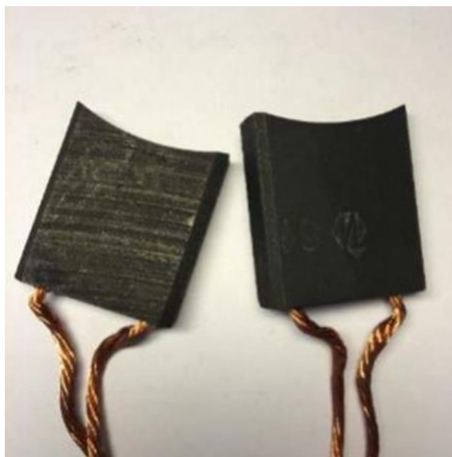
Рисунок 4 – Состояние ЭЩ узла заземления при усилии 4,0 кгс
