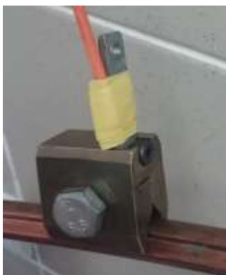
Рис. 4. Датчик ускорения, выполненный в форм-факторе струнового зажима
