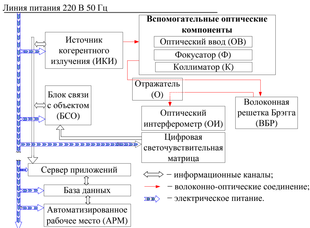
Рис. 8. Структурная схема измерения температуры проводов контактной сети на основе волоконно-оптических элементов
