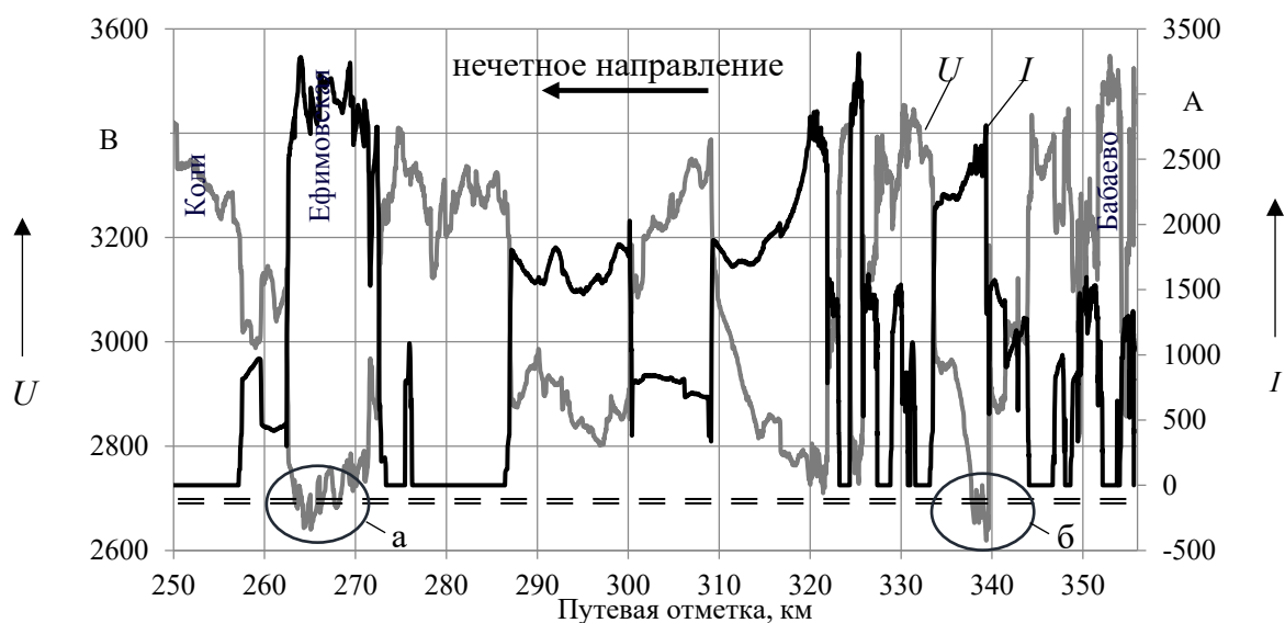
Рисунок 5.1 – График тока поезда и напряжения с локомотивом серии ЗЭС4К (масса поезда 9006 т)
