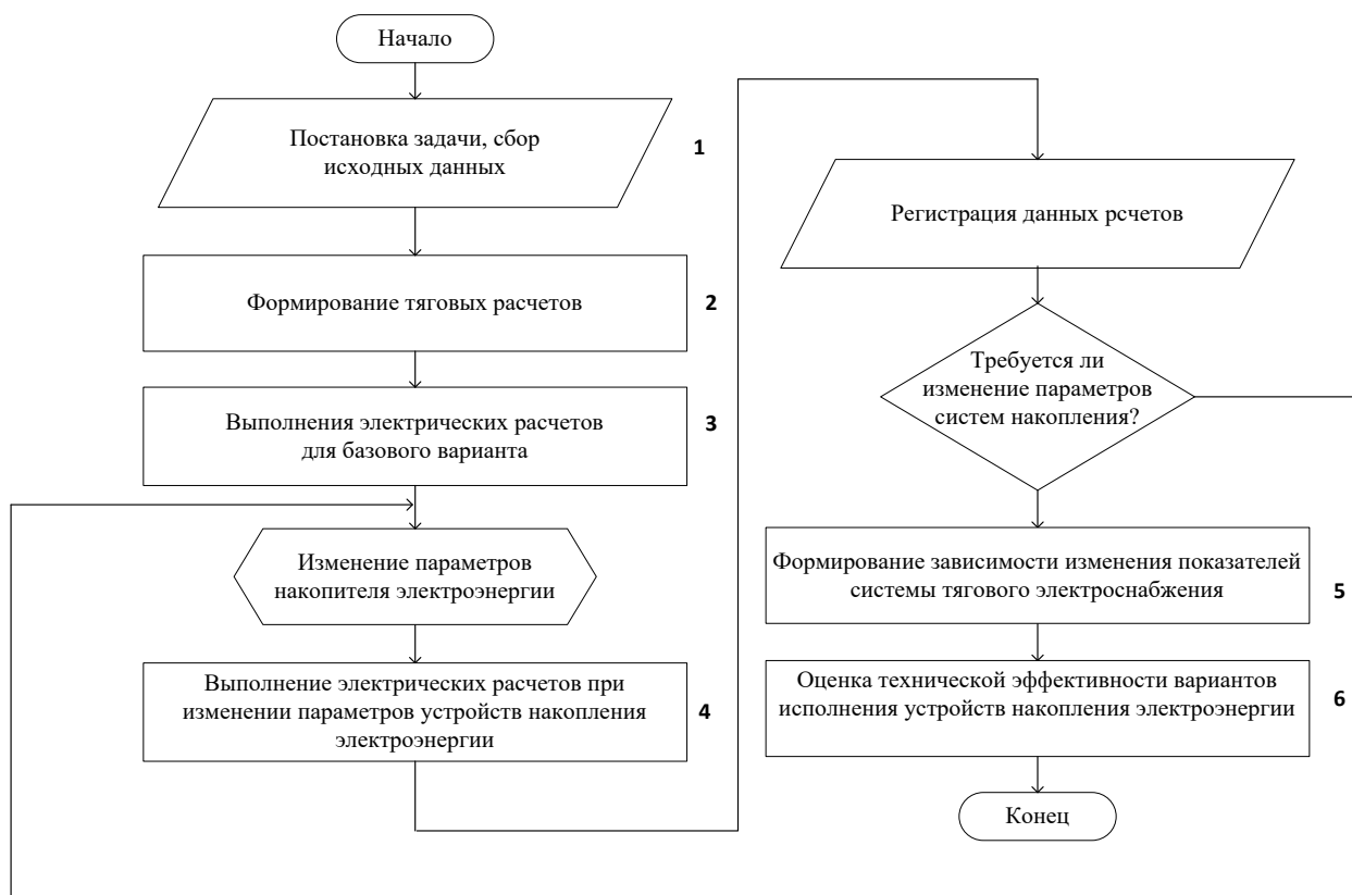
Рисунок 7.32 – Алгоритм оценки влияния систем накопления электэнергии на показатели работы системы тягового электроснабжения
