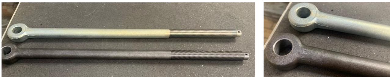
Рисунок 2 – Деталь «тяга» до и после гальванического цинкования
