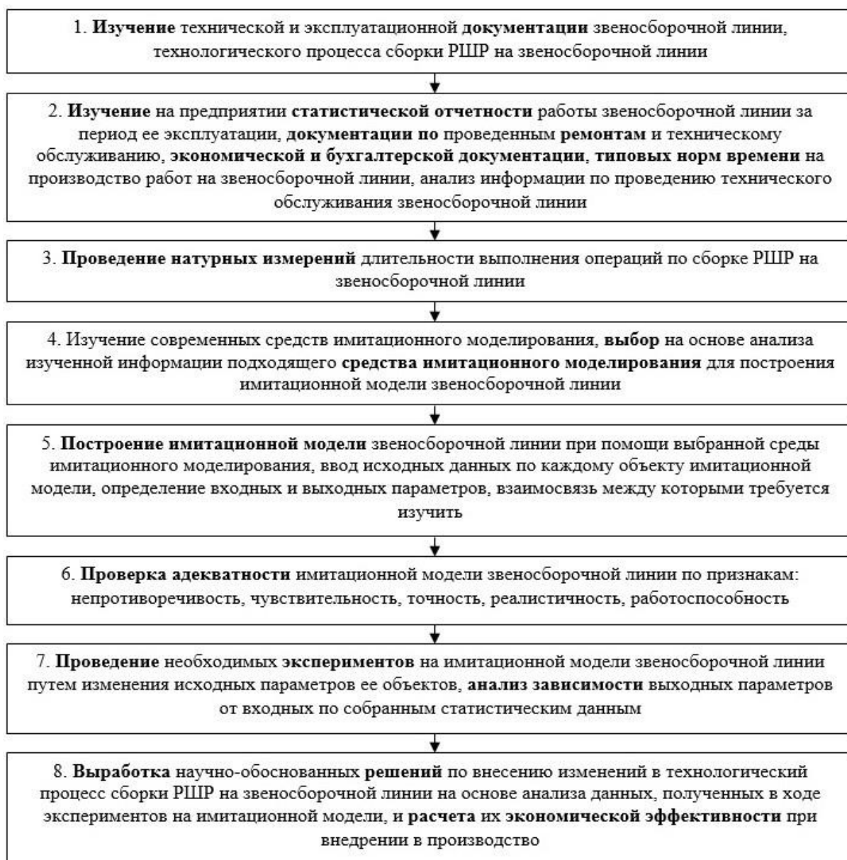
Рисунок 2 – Этапы создания имитационных моделей автоматизированных звеносборочных линий
